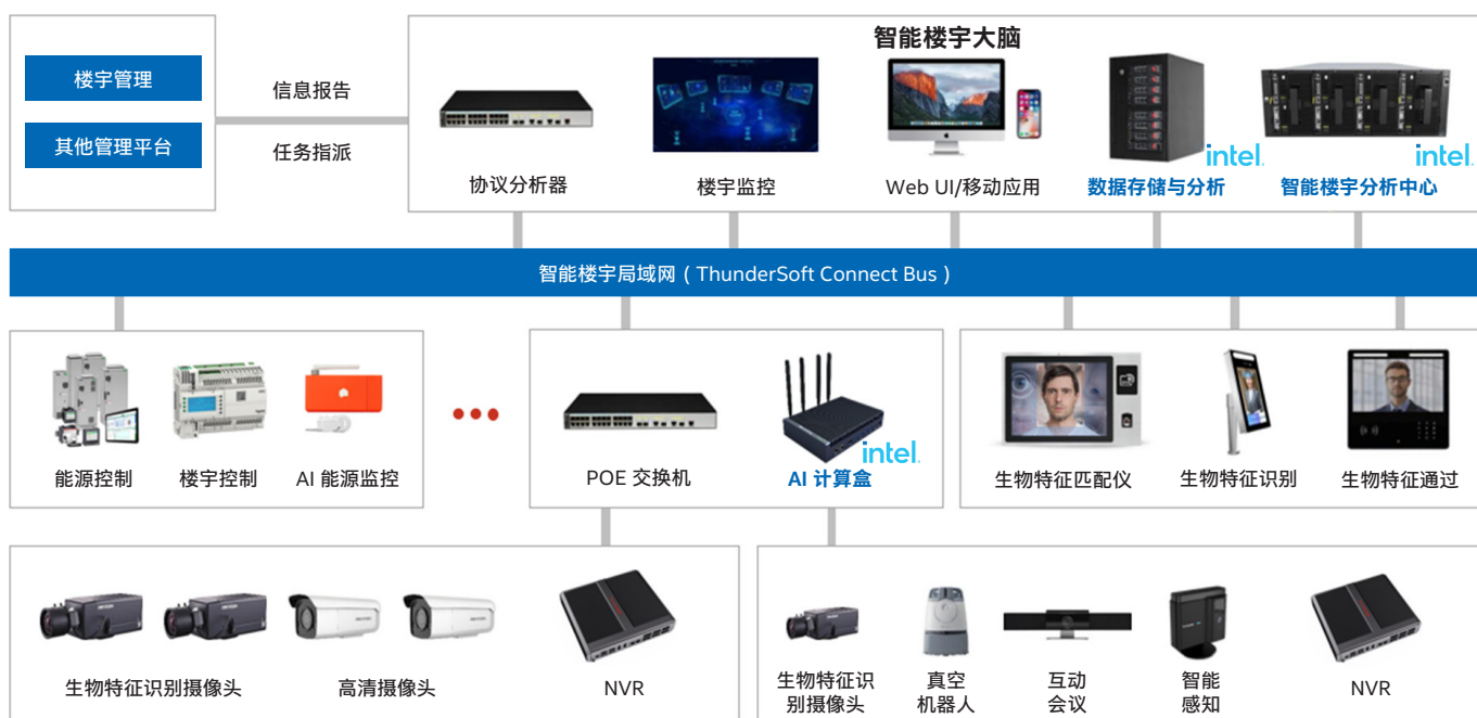
图 5. 面向该企业的中科创达智慧楼宇方案架构图
